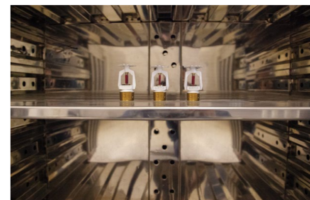
آزمون های مقاومت به دمای بالا مطابق استاندارد DINEN 12259
