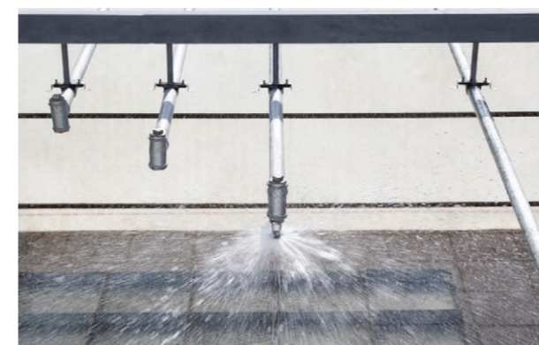
آزمایش توزیع آب بر حسب مساحت پوشش مطابق با استاندارد UL199
