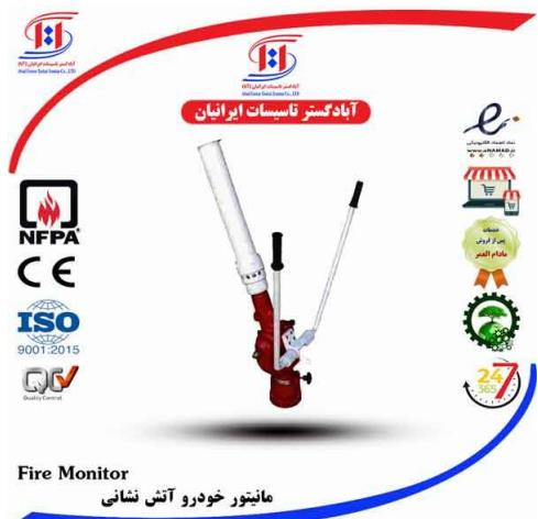
۱۸. ظرفیت مانیتور سه هزار الی چهار هزار و پانصد لیتر بر دقيقه با فشار هشت الی دوازده بار می‌باشد.
